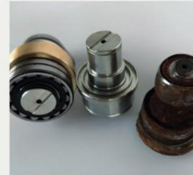
**Wellenlager mit Ölschlitz und schadhaftes Bauteil.** Foto: Werkbild
